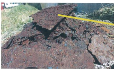
23. kép A torony aljából kiszedett rozsdás darab
