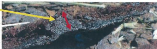
24. kép A torony aljából kiszedett rozsdadarab keresztmetszete vastagsága
