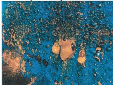
21. kép Csőoszlop belső felülete
